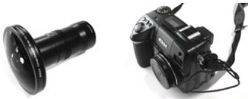
Figuur 1.50 Coolpix-camera en vissenoog lens gebruikt bij het maken van luminantieweergaven.
